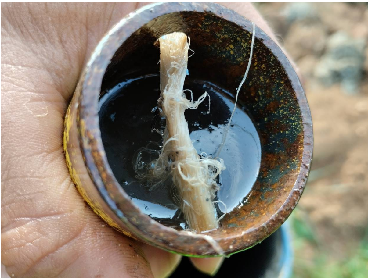
Foto 51 – HV110 (+vzorkovnice s organickou kapalinou vytaženou při odběrech vzorků podzemní vody)
