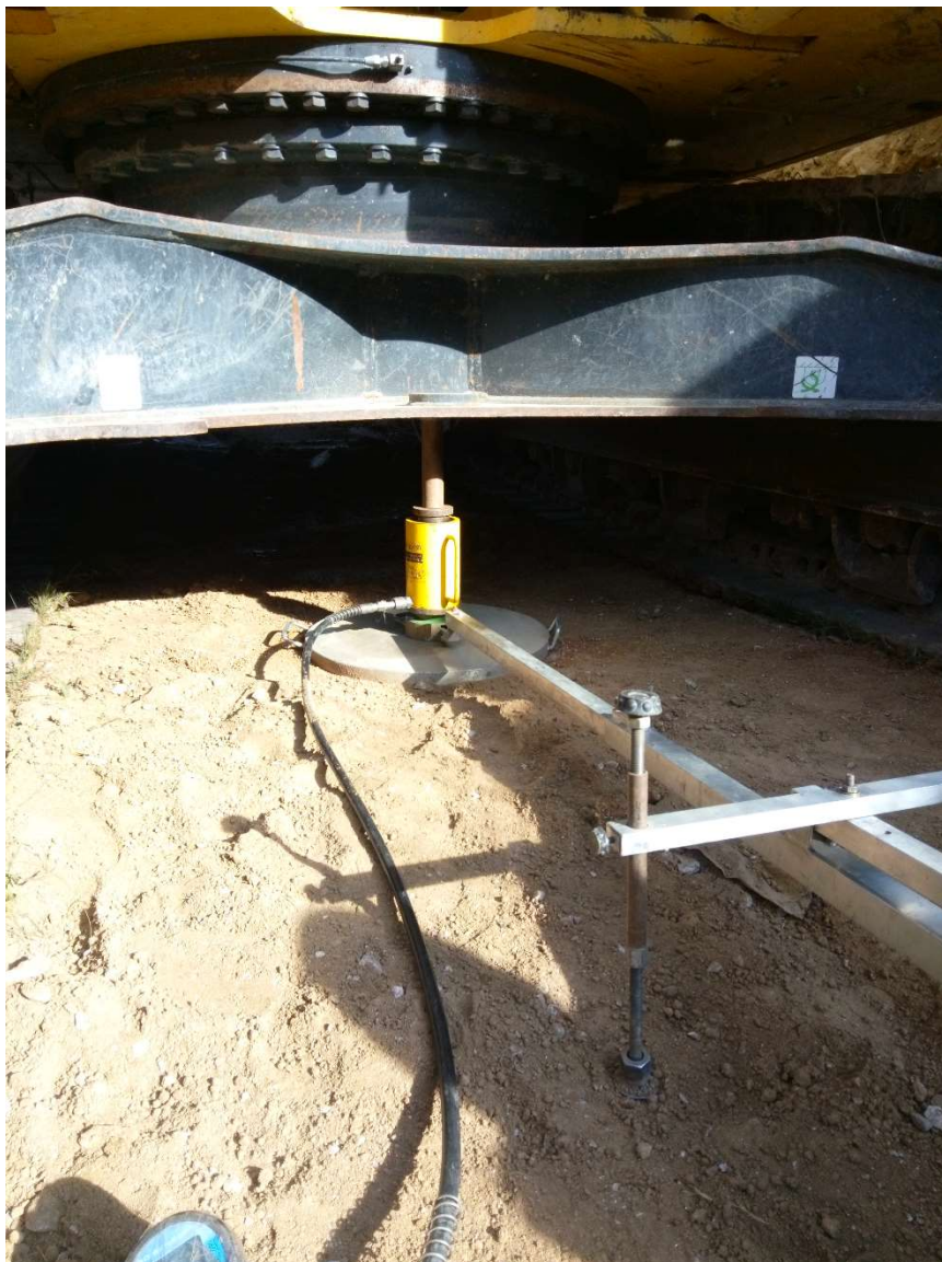
Foto 45 – Realizace bagrované sondy BG151 + realizace statické zátěžové zkoušky deskou SZZD 1
